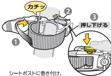
シートポストに巻き付け、ストラップピンをロックレバーにはめ込みます。
