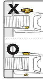
固定ノブを押し下げてストラップ位置を固定します。
