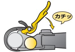
ロックレバーを倒し、ディフェンダーiGlowをシートポストに固定します。
