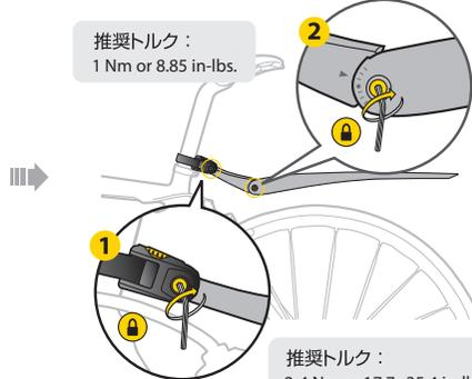
角度とタイヤクリアランスが適切になるよう調整し、角度調整ボルトを締めてください。
